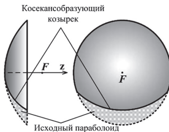
Рис. 10.13 Зеркальная антенна с косекансообразующим козырьком
