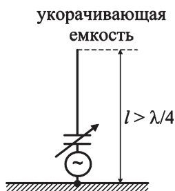
Рис. 6.16 Схемы настройки антенны при l \neq \lambda/4
