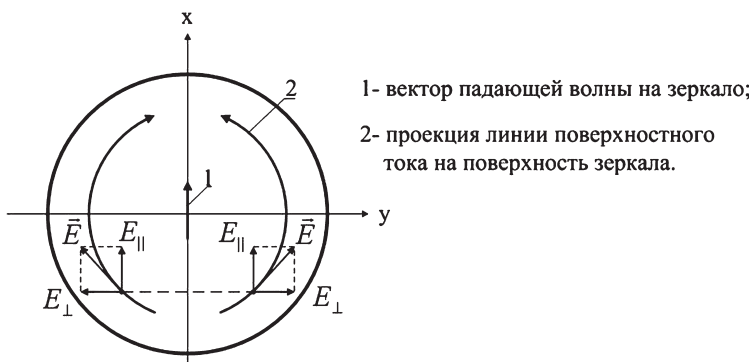
Рис. 10.17 Явление кроссполяризации в зеркальных антеннах
