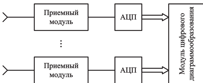
Рис. 16.21 Структурная схема приемной ЦАР
