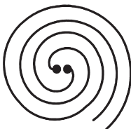
Рис. 11.7 Плоская спиральная антенна:
